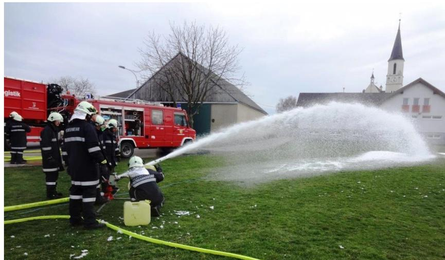
Zusätzlich wurde das Schaumrohr auf den Wasserwerfer aufgebaut um damit die höhere Wurfweite und den höheren Schaummittelverbrauch zu erkennen.
