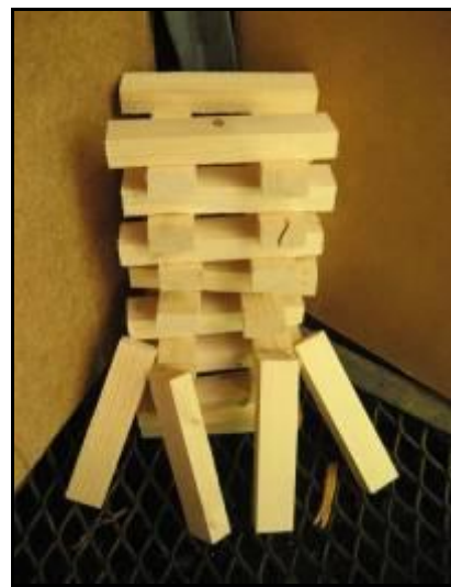
Weichholzstapel und 2 Stück kleine Holzplatten für das Initialfeuer
