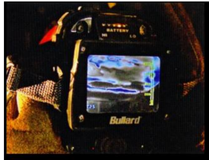
Rauchschichtanalyse mit WBK
