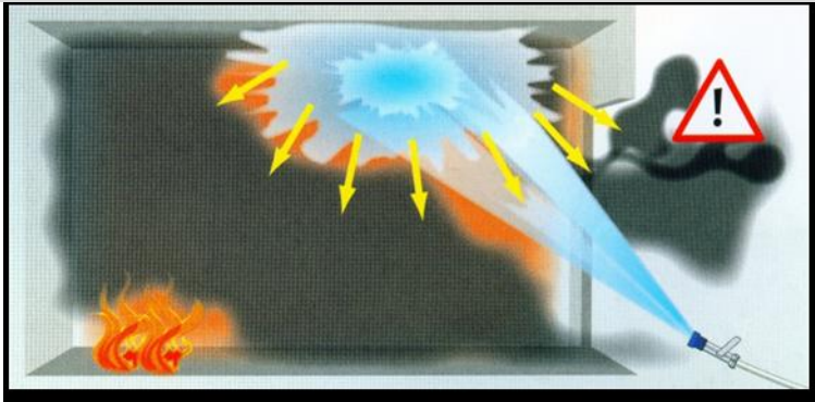
Falsche Strahlrohrführung bei der Rauchgaskühlung
